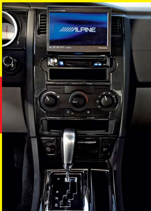
Jednostka sterująca Alpine IVA-D310 oraz LCD TME-M770S zostały wbudowane w „karbonową” konsolę środkową
